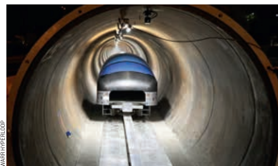
Prototypen af Hyperloop accelererer fra 0 til 324 km/t i en tunnel med vakuum på få sekunder.
